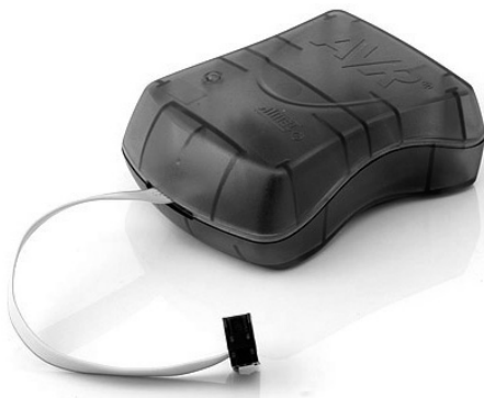
Рис. 1.2. AVR программатор ISP MKII
